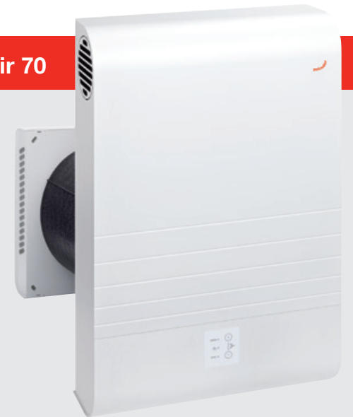
Két helyiség szellőztetésére alkalmas hővisszanyerő berendezés, két ventilátorral, ellenáramú entalpia hőcserélővel.
